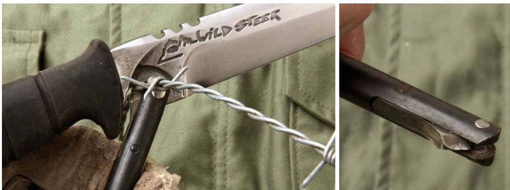
Drahtschneider: Der Klingenhaken ist ein konstruktives Merkmal, das sich schon beim allerersten Modell fand. Er lässt sich mit Hilfe des neuen Zusatzwerkzeugs (mit Schneideinsatz) auch nutzen, um Draht zu kappen.
